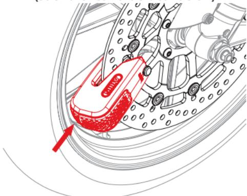
**7.3** Tirar ligeramente del cuerpo del antirrobo, el antirrobo se abre automáticamente
