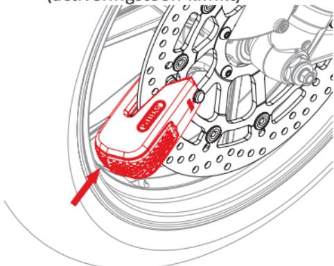
**7.3** Slotlichaam met lichte kracht van remschijf wegtrekken, slot opent automatisch
