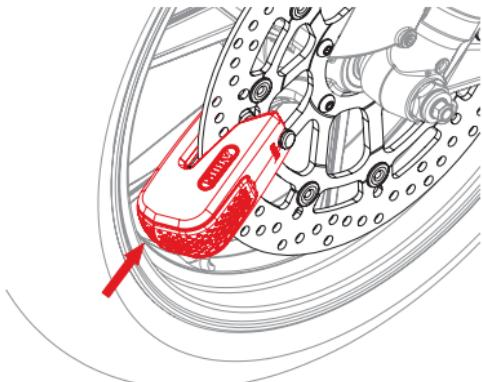
**7.3** Легким усилием отвести корпус замка от тормозного диска, замок открывается автоматически.
