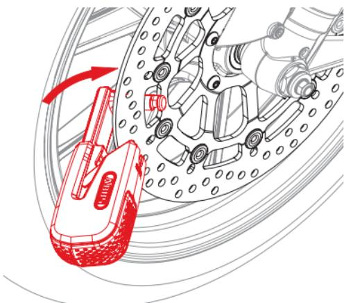
**5.2** Slot dichtdrukken (bevestigingstoon klinkt 2x) na 5 sec.
