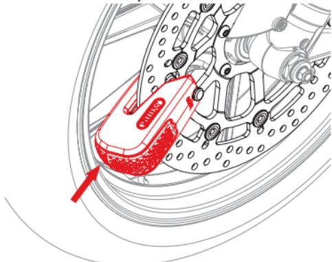
**7.3** Træk selve låsen væk fra bremseskiven med let kraft, låsen åbner automatisk
