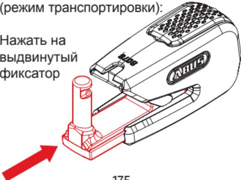
**8.2** Раздается звуковой сигнал «Активирован режим транспортировки»
