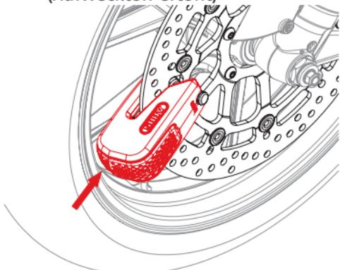
**7.3** Schlosskörper mit leichter Kraft von Bremsscheibe wegziehen,
